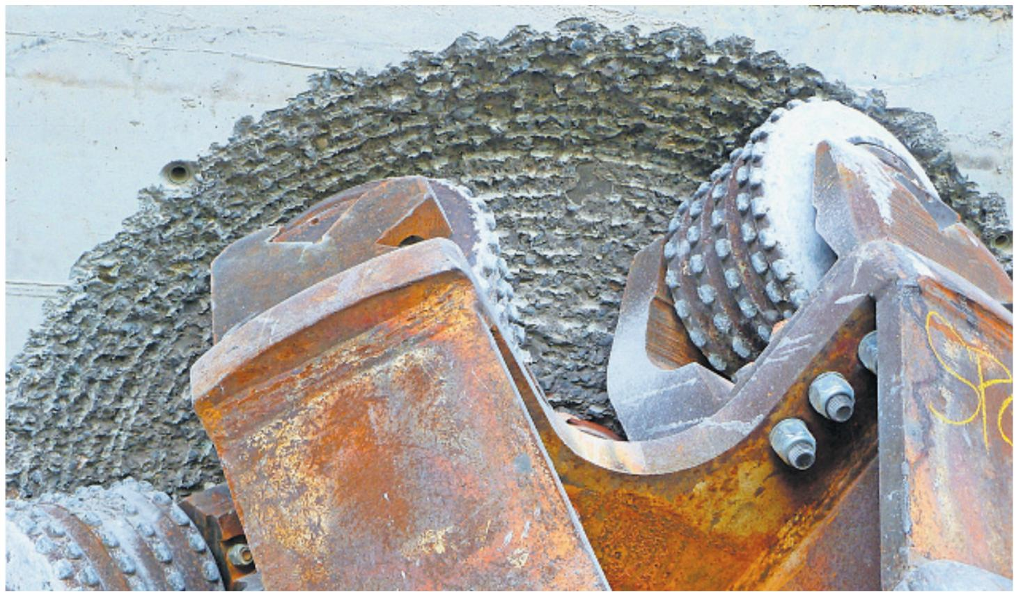
Der Bohrkopf wurde vom 4. bis am 21. August am Bohrgestänge in der Pilotbohrung von unten nach oben gezogen.
